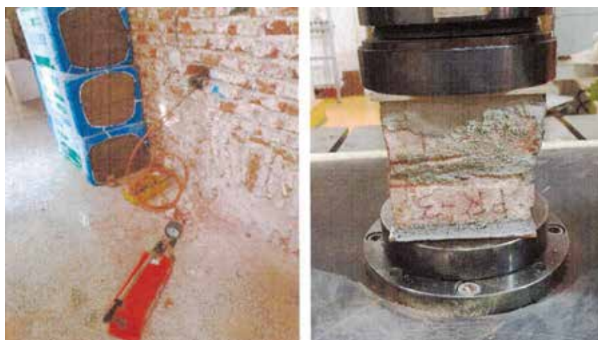
Ispitivanje posmične čvrstoće zida (lijevo), ispitivanje tlačne čvrstoće opeke u laboratoriju (desno)
